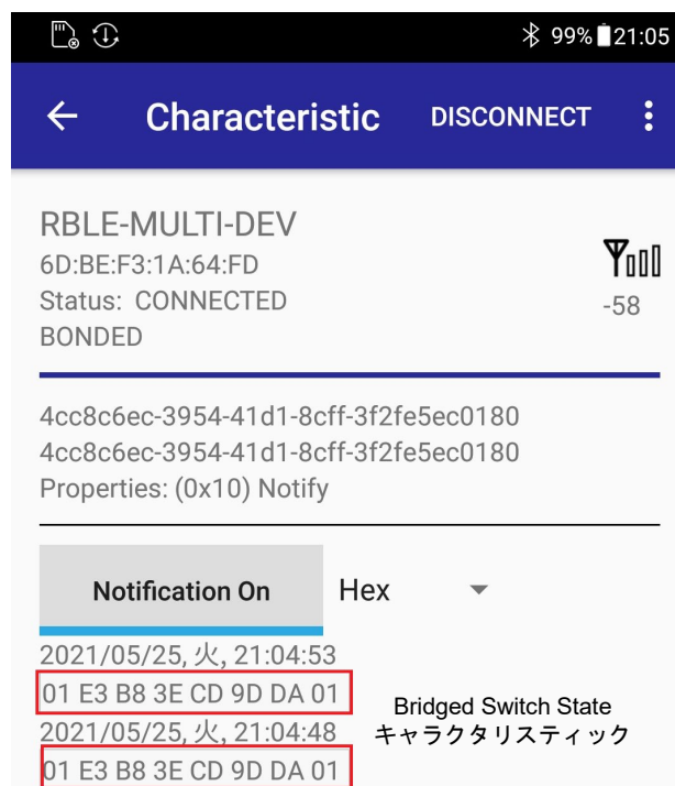
図 12-11 Central デバイスへの Bridged Switch State キャラクタリスティックの通知
