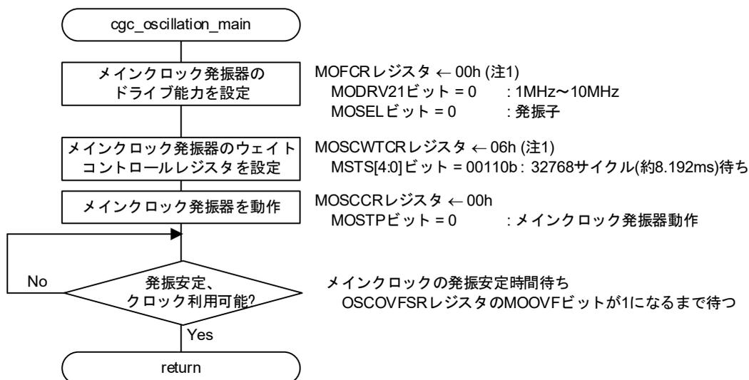
図 3.5 メインクロックの発振設定
