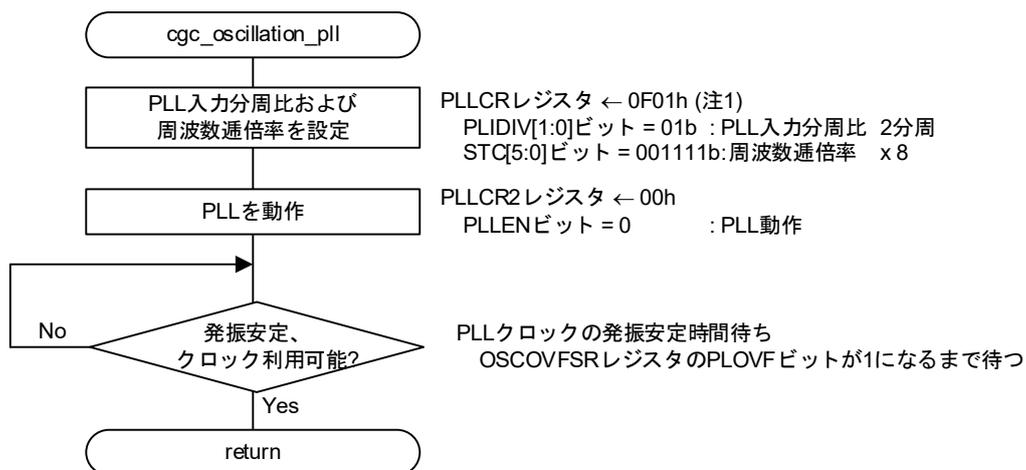
図 3.7 PLL クロックの発振設定
