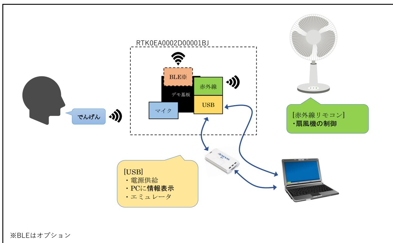
Figure 1-1 RX231 音声認識リモコン デモセット
