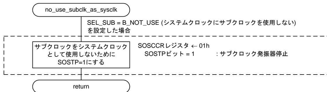
図 4.13 サブクロックをシステムクロックに使用しない場合の設定
