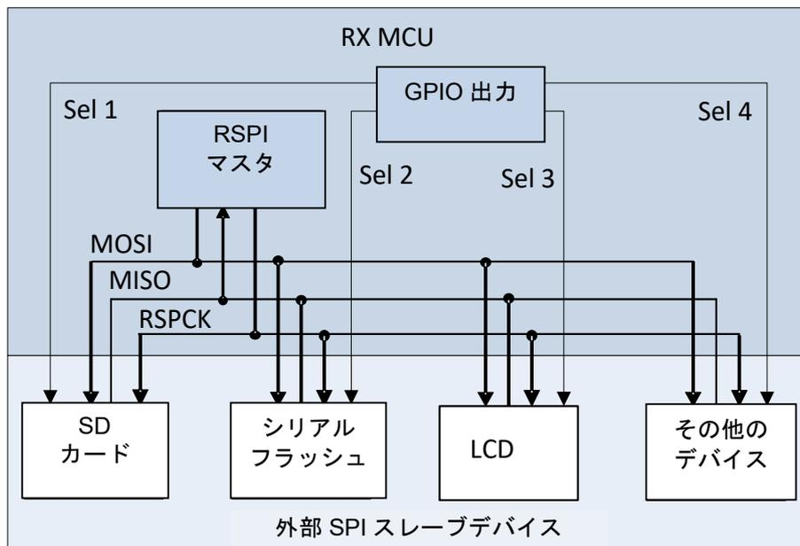
図 1-2 GPIO ポートのスレーブセレクト信号として使用する例 (3 線モード)
