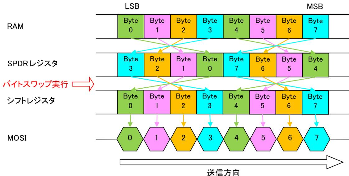
図 1-9 データ送信 データ型 32 ビット 【Little エンディアン】 バイトスワップ実行
