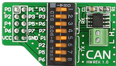
2x3 ヘッダを RSKRX24T の J2 端子 15~20 にはんだ付けされることを推奨します。CAN-1 ボードのディップスイッチライン 1 と 5 は ON にしてください。ボードは以下のように繋いでください。
