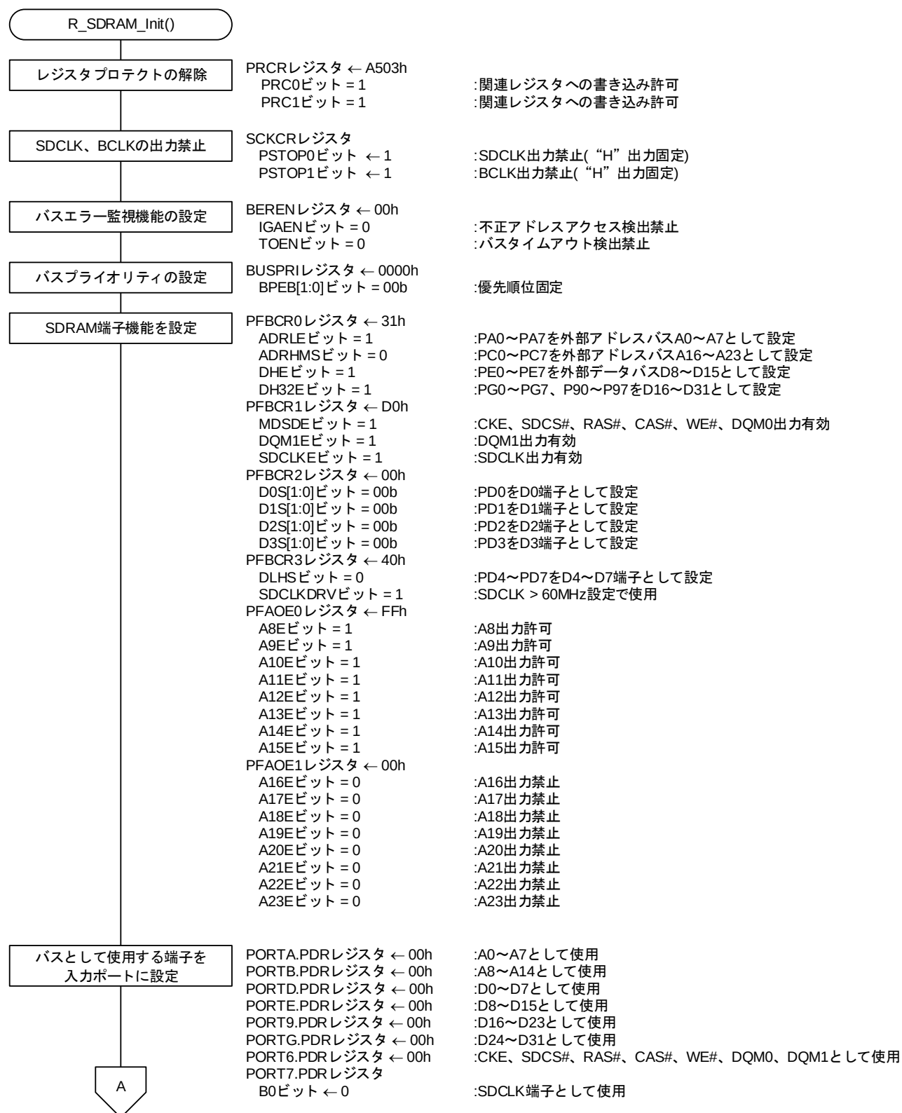
図 6.9 RX72M サンプルコードの SDRAM 初期設定(1/2)
