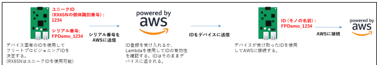
図 2-5 ランダム値またはユニークな ID を使用したモノの名前の決定方法
