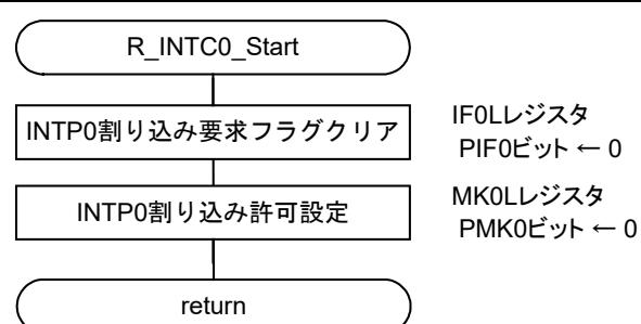
図 6.20 INTP0 動作許可設定
