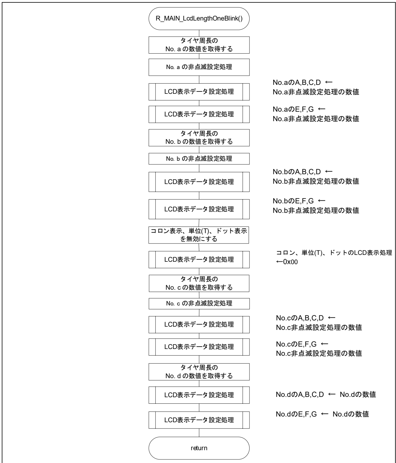
図 4.34 タイヤ周長の一の位の点滅 LCD 表示
