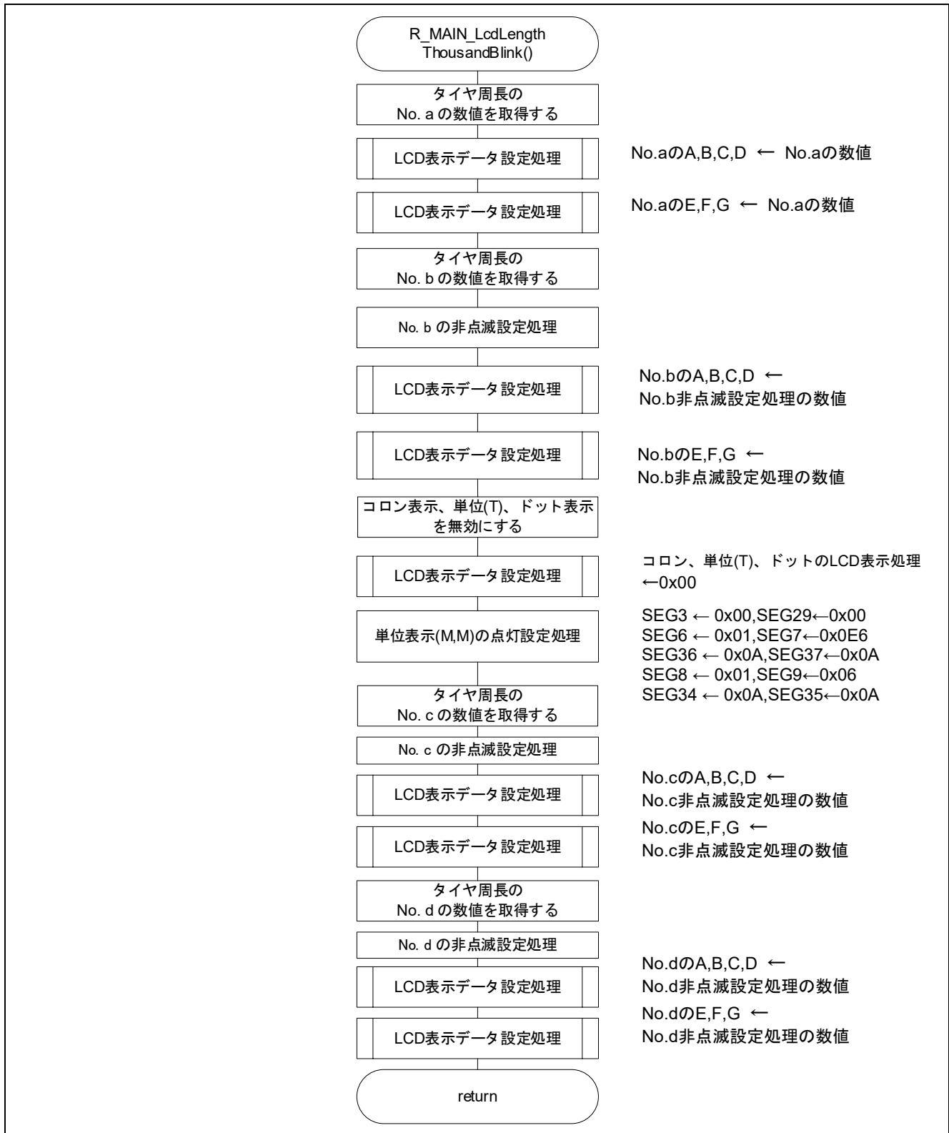
図 4.31 タイヤ周長の千の位の点滅 LCD 表示
