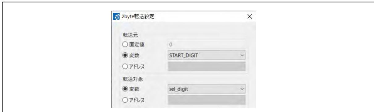
図 6-12 桁選択信号の初期化用 2byte 転送
