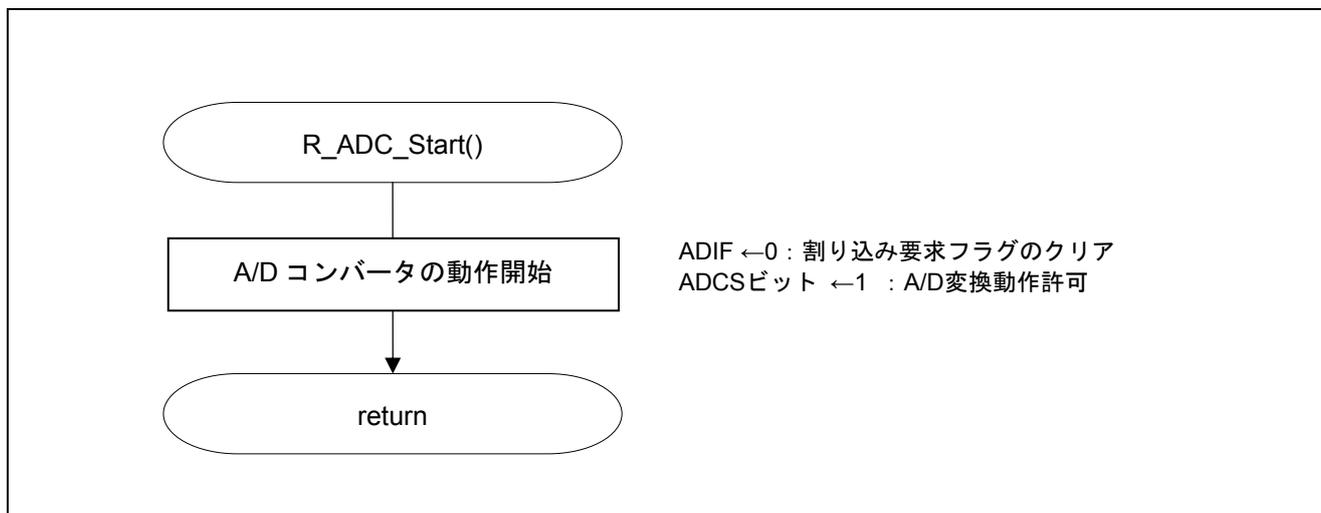
図 5.9 A/D 変換動作開始
