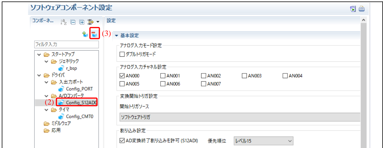
図 4-5 スマート・コンフィグレータでのソフトウェアコンポーネント設定
