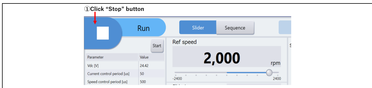
図 4-6 モータ停止の手順
