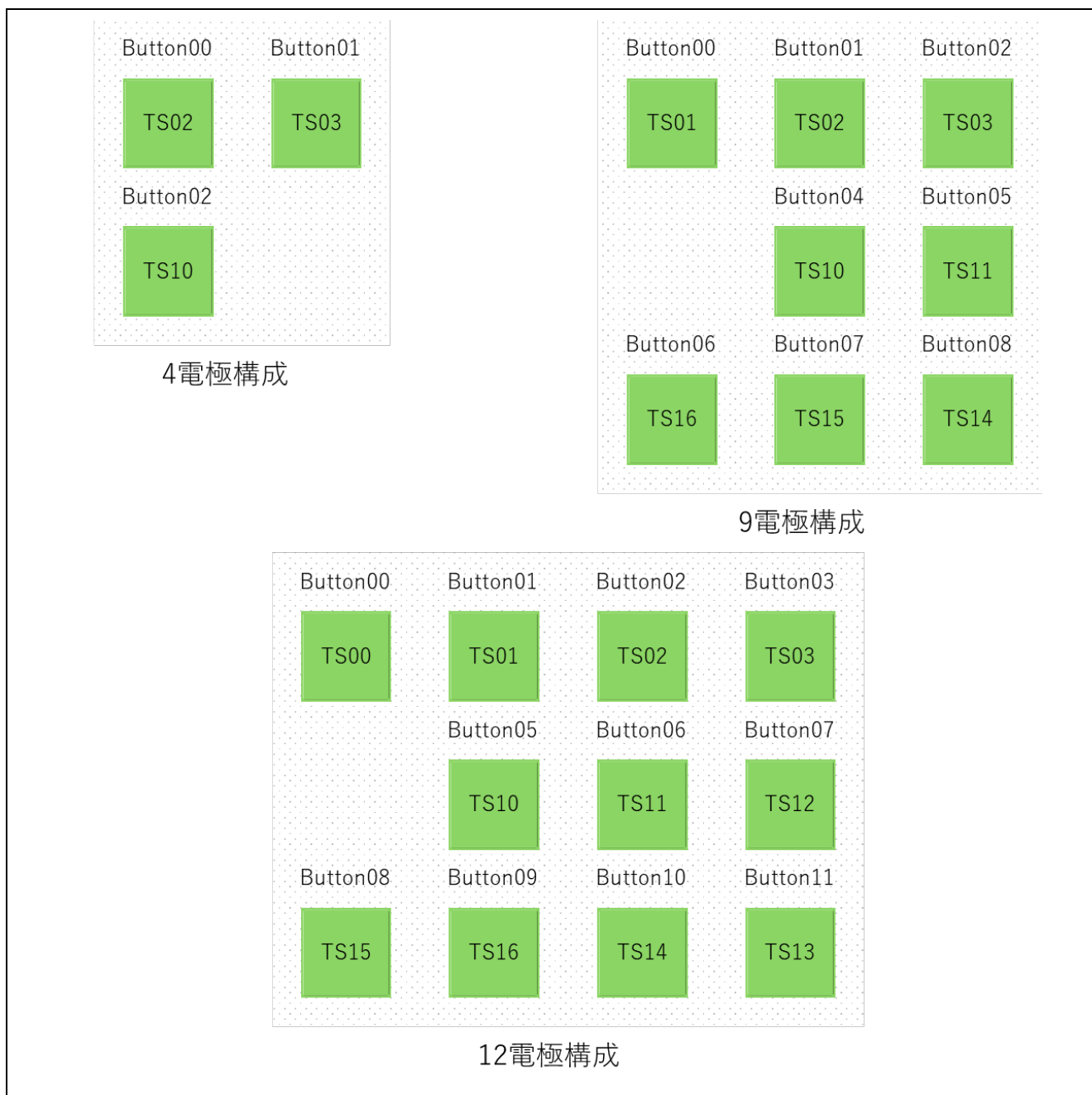
図 5.2 タッチインタフェース構成
