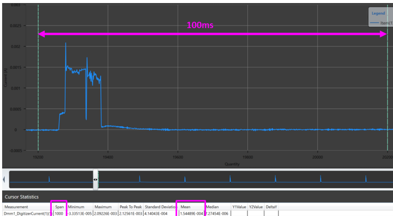
図 5-9 消費電流結果 (TS 端子 1ch 計測)
