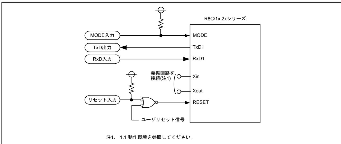
図1.2 標準シリアル入出力モード2の接続例
