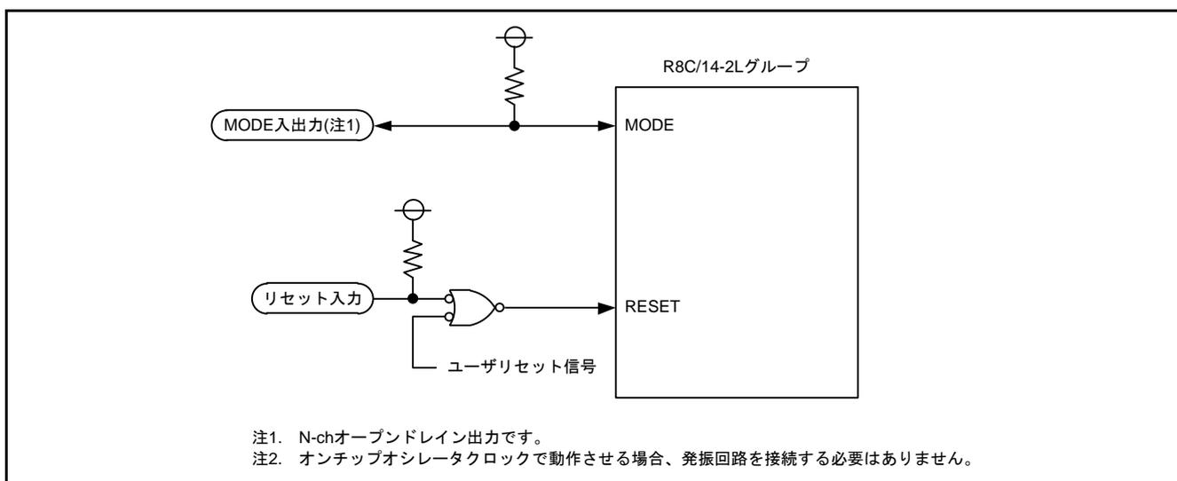
図1.3 標準シリアル入出力モード3の接続例
