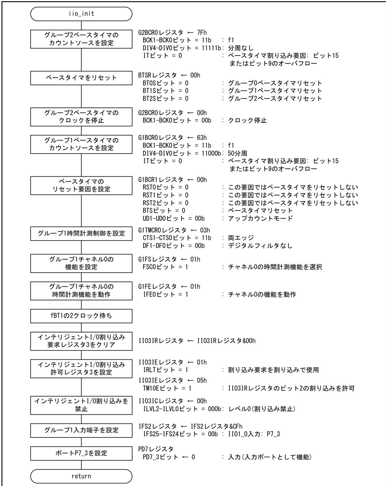
図 6.4 インテリジェントI/O初期設定処理
