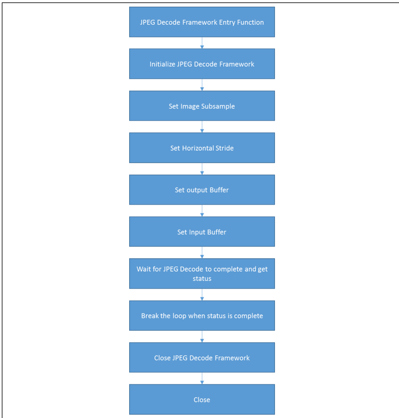
図 6 JPEG デコードフレームワークモジュールのアプリケーションプロジェクトのフロー図
