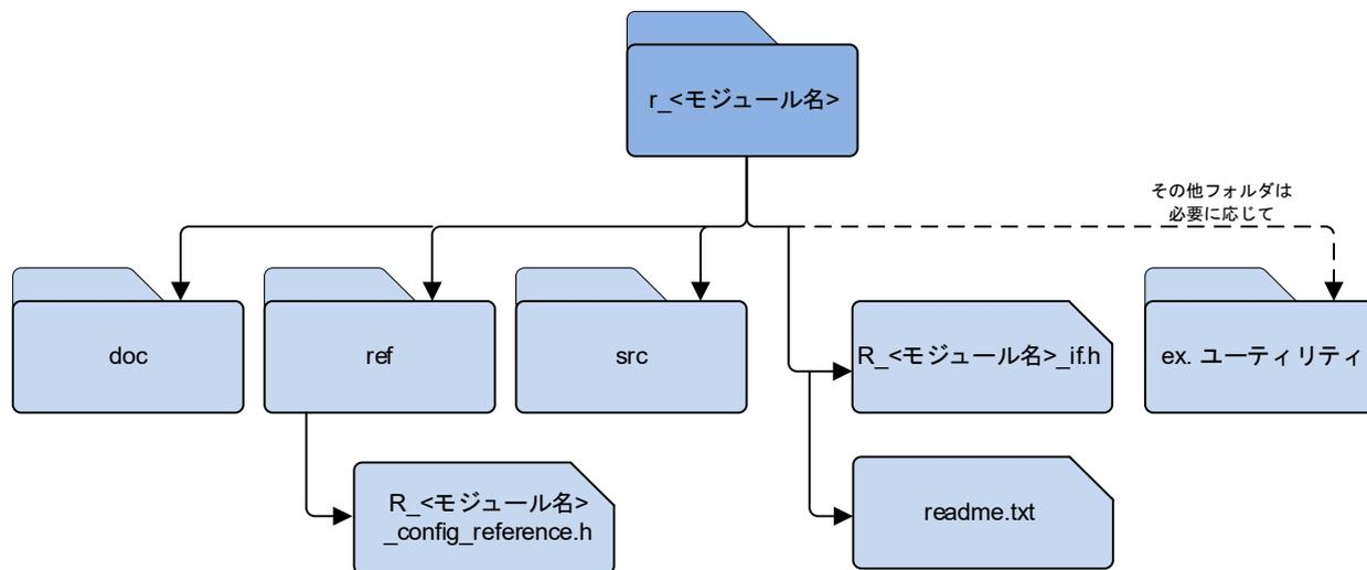
図 3.1 FIT モジュールのファイル構成
