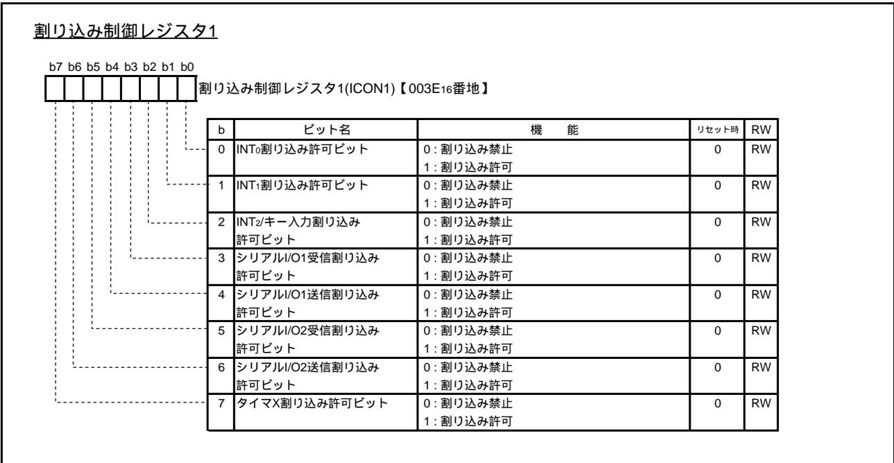
図4.32 割り込み制御レジスタ1の構成
