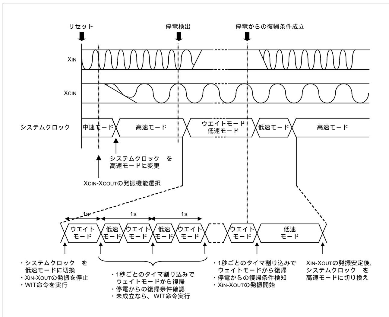
図3.1 停電時のシステムクロックのモード移行例
