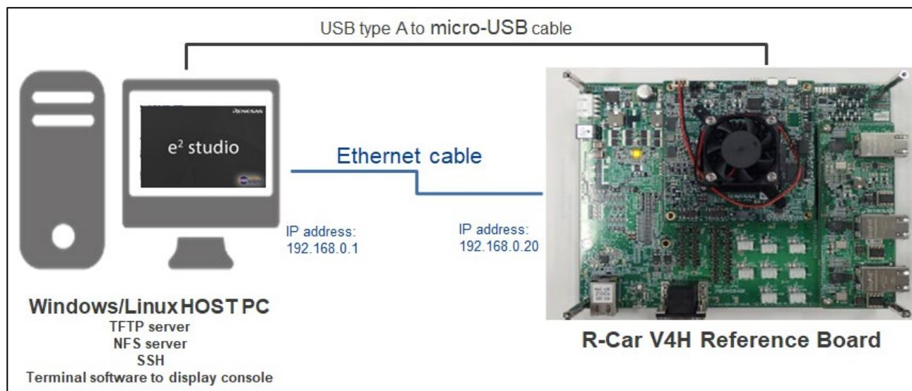
図 2-1 Host PC と Reference Board の接続図
