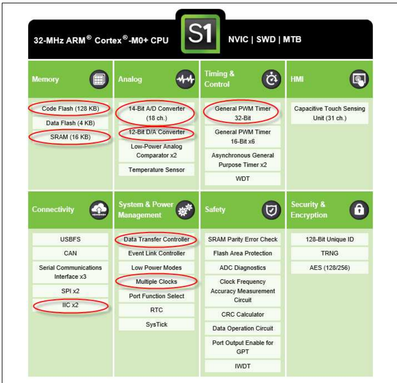
図 2.1 トーンジェネレータサンプルが使用する S1 周辺機器
