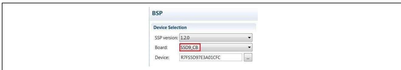
図 18 新規作成したカスタムボードサポートパッケージ (BSP) を選択してテストする
