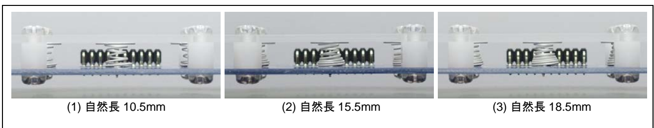
図 6-25 スプリング圧縮評価の評価ボード (つづみ型の例)
