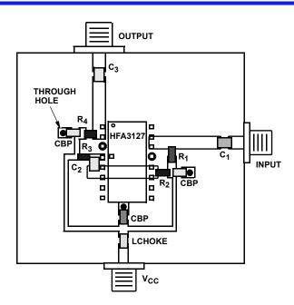
FIGURE 4. MICROSTRIP BOARD LAYOUT FOR THE HIGH-GAIN LOW-NOISE AMPLIFIER
