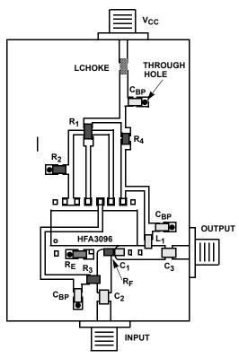
FIGURE 9. MICROSTRIP BOARD LAYOUT FOR THE WIDEBAND
