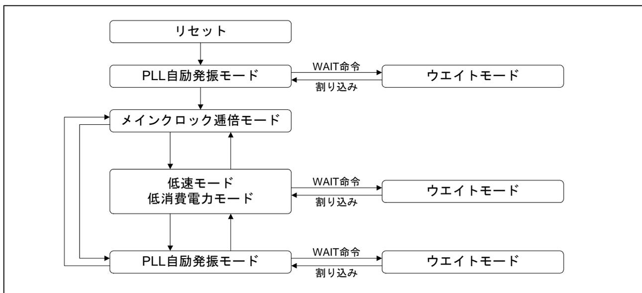
図 1 ウェイトモードへの状態遷移図
