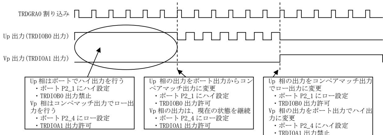
※ U<sub>p</sub> 相の出力において、“ポート P2\_1 にロー設定”かつ“TRDIOB0 出力禁止”に設定した場合、U<sub>p</sub> 出力 (TRDIOB0 出力) は、ロー出力になります。
