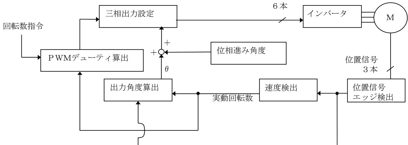
図 3.3.3  $180^\circ$  通電正弦波駆動時の制御ブロック図
