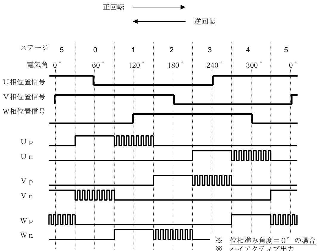
※ 角度の定義として、角度の  $0^\circ$  は、正回転時は V 相位置信号立ち上がりエッジ、逆回転時は V 相位置信号立ち下がりエッジとしています。
