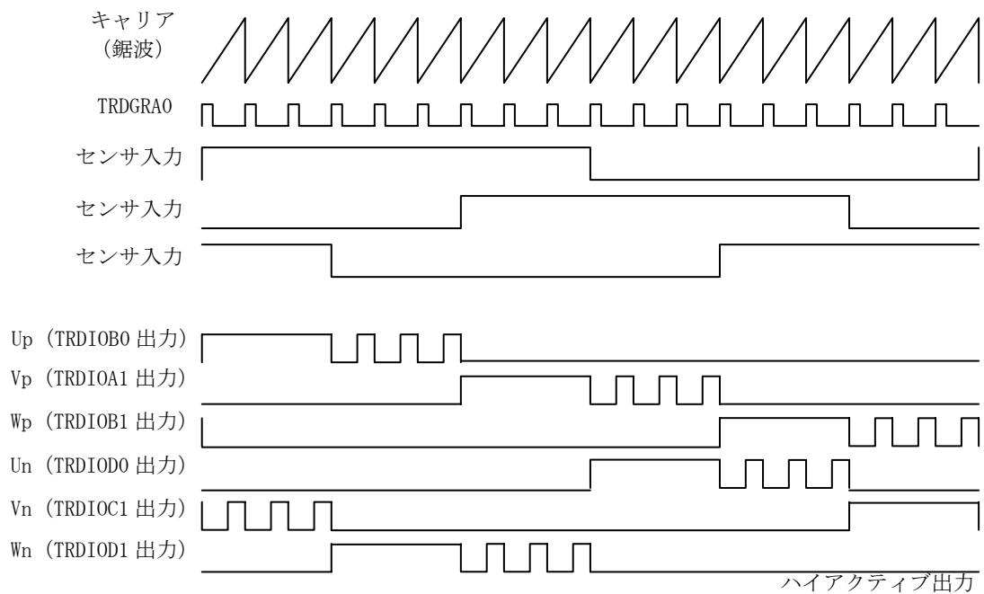
図 3.2.6  $120^\circ$  通電矩形波駆動のセンサ入力と波形出力の関係
