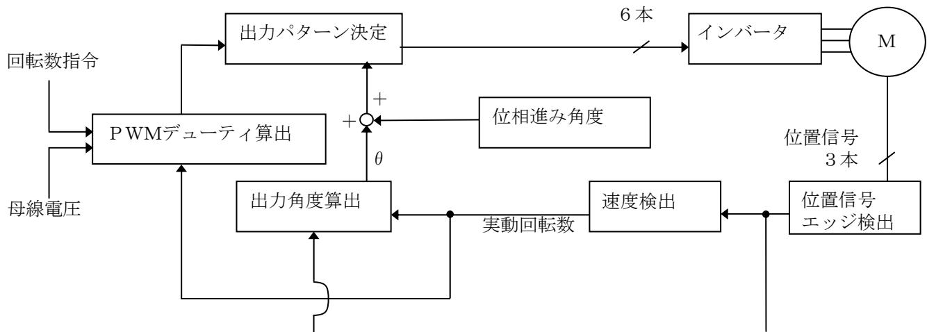
図 3.3.2  $120^\circ$  通電矩形波駆動時の制御ブロック図
