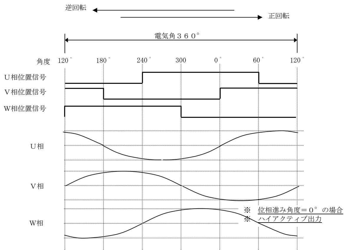
図 3.3.5  $180^\circ$  通電正弦波駆動時の 位置信号と 三相出力波形の関係
