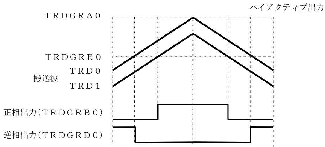
図 3.1.4 PWM出力方法(相補PWMモード)
