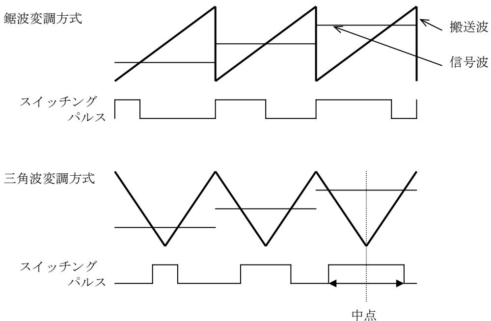
図 3.2.3 キャリアの変調方式
