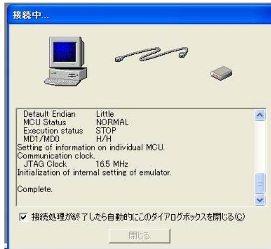
図 3-5 E1 エミュレータ接続中ダイアログ 2
