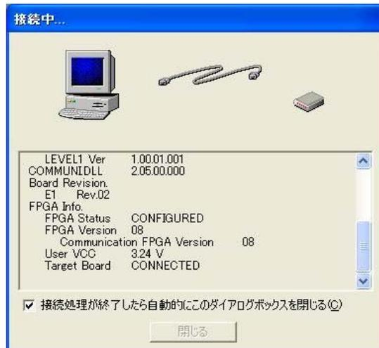
図 3-3 E1 エミュレータ接続中ダイアログ 1
