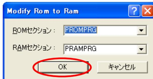
以下のように表示され、フラッシュメモリ領域にあるセクション“PROMPRG”が、内蔵 RAM 領域にセクション“PRAMPRG”としてマッピングされます。[OK]ボタンを押して[H8S, H8/300 Standard Toolchain]ダイアログボックスを閉じてください。
