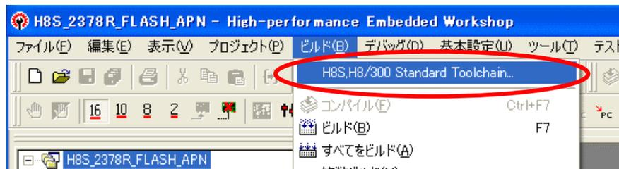
[H8S, H8/300 Standard Toolchain]ダイアログボックスが表示されるので、[コンパイラ]タブの[カテゴリ]欄を“オブジェクト”にして[出力ファイル形式]欄を“アセンブリプログラム(\*.src)”に変更します。
