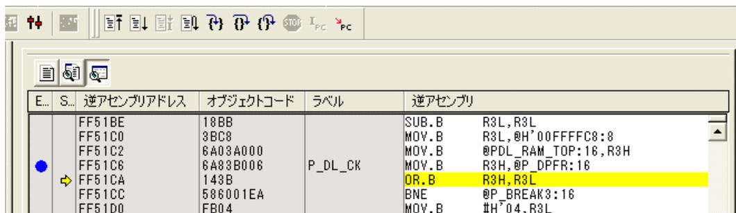
HEW のメモリウィンドウを表示させて DPFR の値 (ダウンロード先の先頭アドレスの値)を確認してください。サンプルプログラムでは、ダウンロード先の先頭アドレスをシンボル“PDL\_RAM\_TOP”で設定しているのので、“H' FFA000”番地の値が DPFR の値になります。
