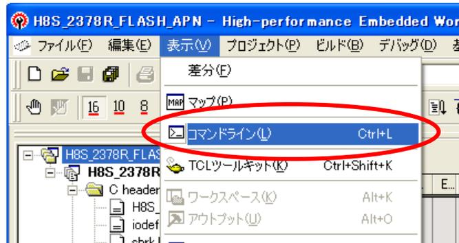
コマンドラインウィンドウで以下のように“mf 0x001000 0x07FFFF 11”と入力してコマンド実行してください。“0x001000~0x07FFFF”は今回の消去対象ブロックのアドレスで、“11”は任意の値です。
