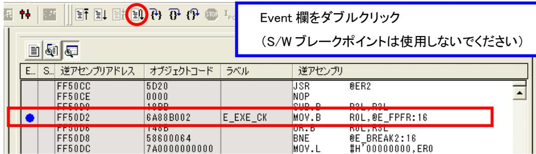
(12) ブレークを設定した箇所でプログラムが停止します。HEW のレジスタウィンドウを表示させて FPFR の値 (汎用レジスタ R0L の値)を確認してください。
