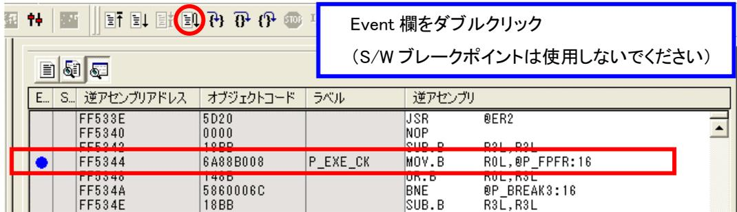
上記箇所にブレーク設定してプログラムを実行すると、IIC バスインタフェース 2 のチャンネル 0 (IIC2\_0) によるスレーブ受信モードに入り、IIC\_マスタ送信側からデータが送信されるまで待機状態となります。プログラム実行後にフラッシュメモリに書き込むデータを送信してください。
