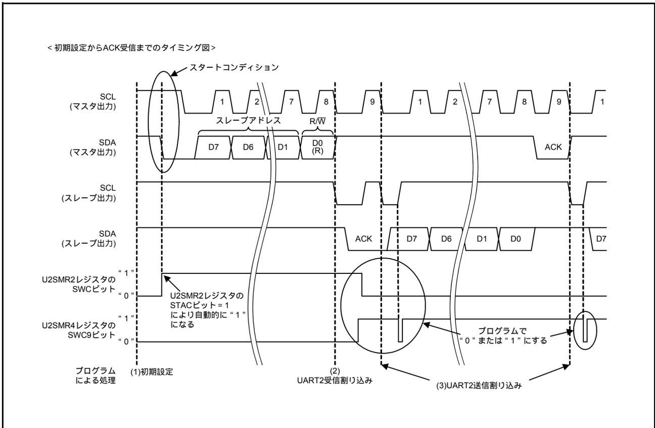
図 3.5 スレーブ送信のタイミング図(1)
