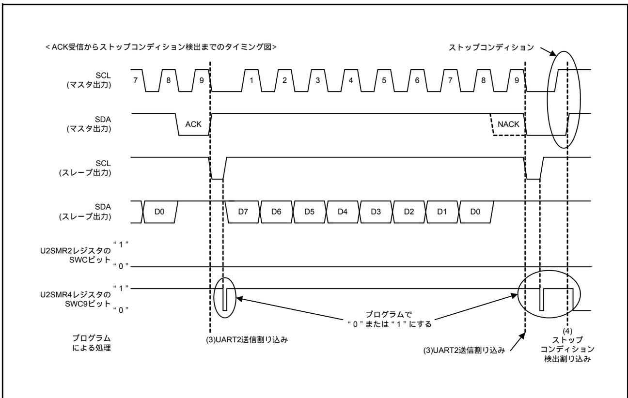
図 3.6 スレーブ送信のタイミング図(2)
