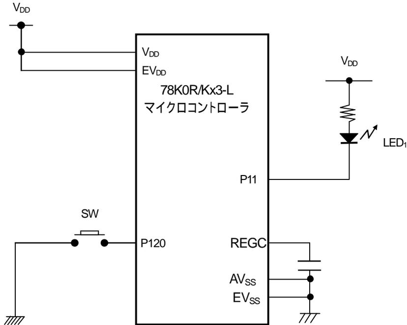
注意：この回路イメージは接続の概要を示す為に簡略化しています。実際に回路を作成される場合は、端子処理などを適切に行い、電流など電気的特性を満たすように設計してください(P121 ~ P124は入力専用ポートになりますから個別に抵抗を介して $V_{DD}$ 又は $V_{SS}$ に接続して下さい)。
