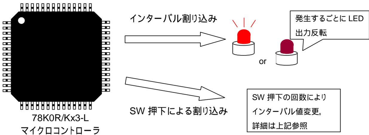
インターバル割り込み発生の場合は外部出力端子(LED)への出力を反転
