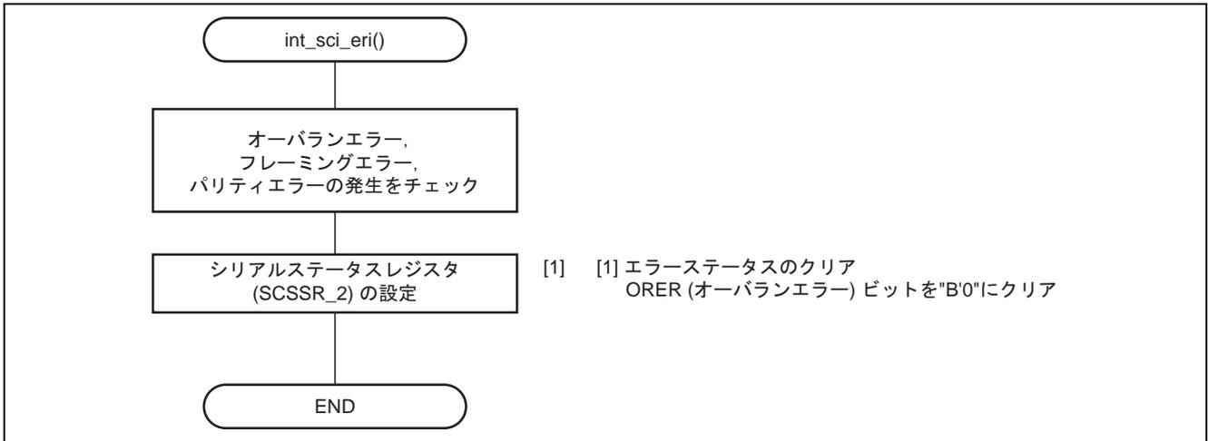
図9 クロック同期式モード受信エラー割り込み処理フロー
