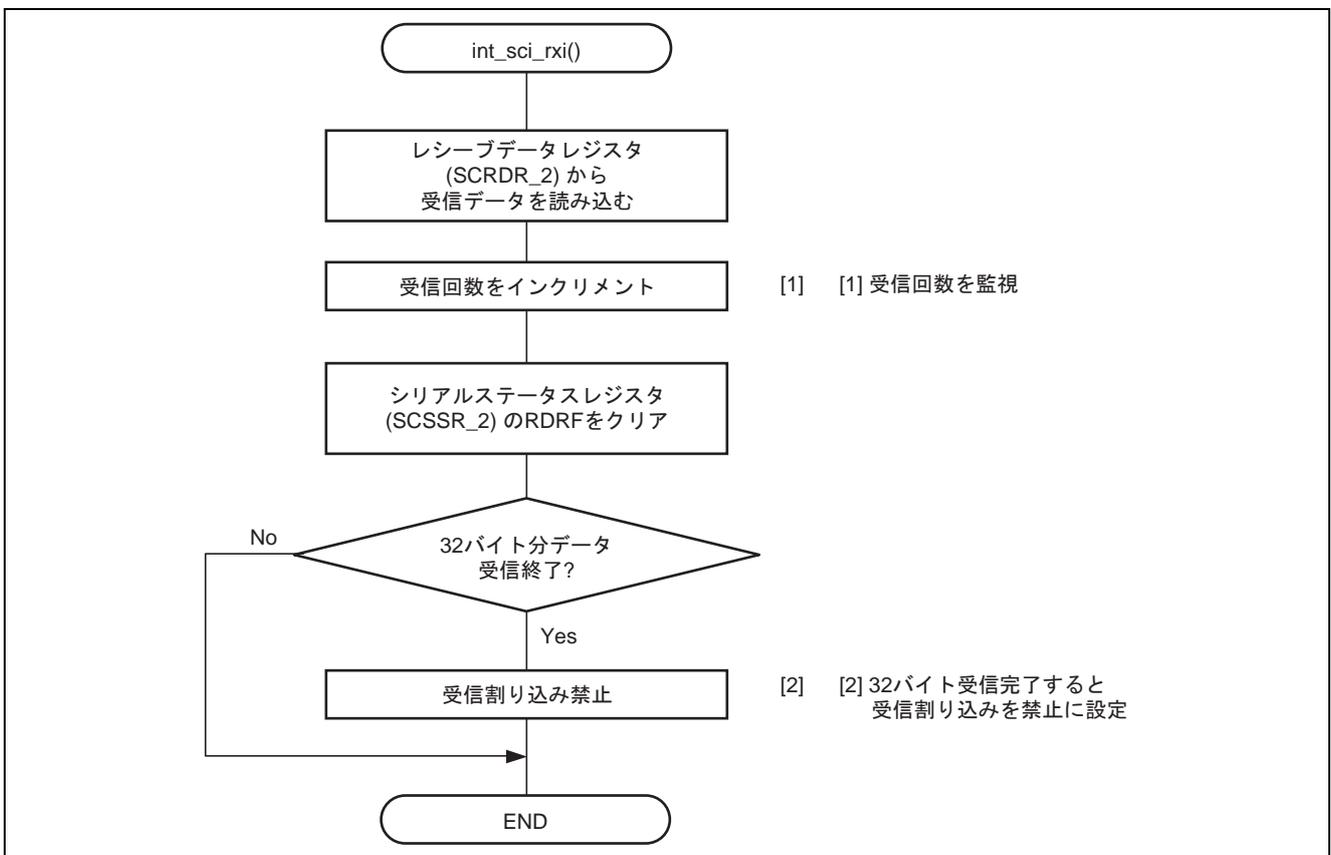
図8 クロック同期式モード受信割り込み処理フロー
