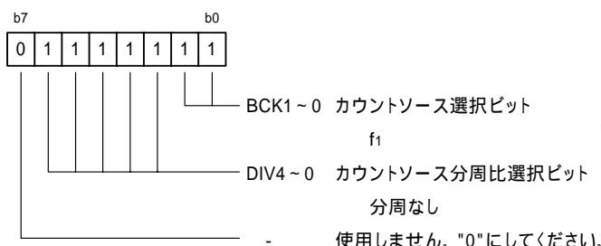
この設定により、以下(6) ~ (13)で示す各レジスタにクロックが供給されます。各レジスタの設定値を設定直後に有効にするため、必ず"01111111<sub>2</sub>"にしてください。
