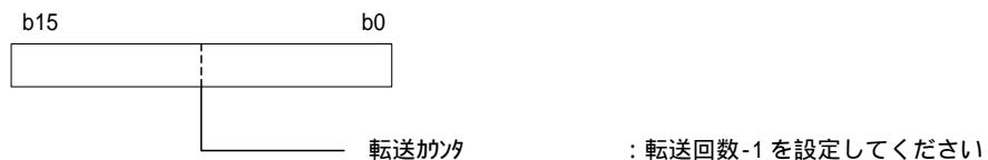
(6) DMA0 割り込み制御レジスタ(DM0IC)を設定する。
