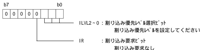
(7) DMA0 制御レジスタ(DM0CON)を再設定する。
