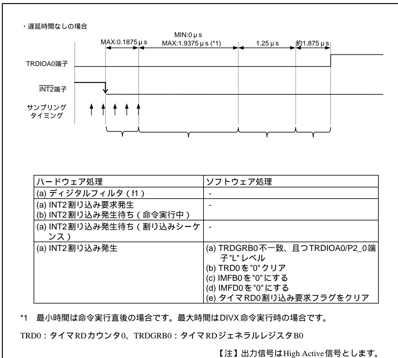
図 4.7 IH 出力信号の再起動の動作原理
