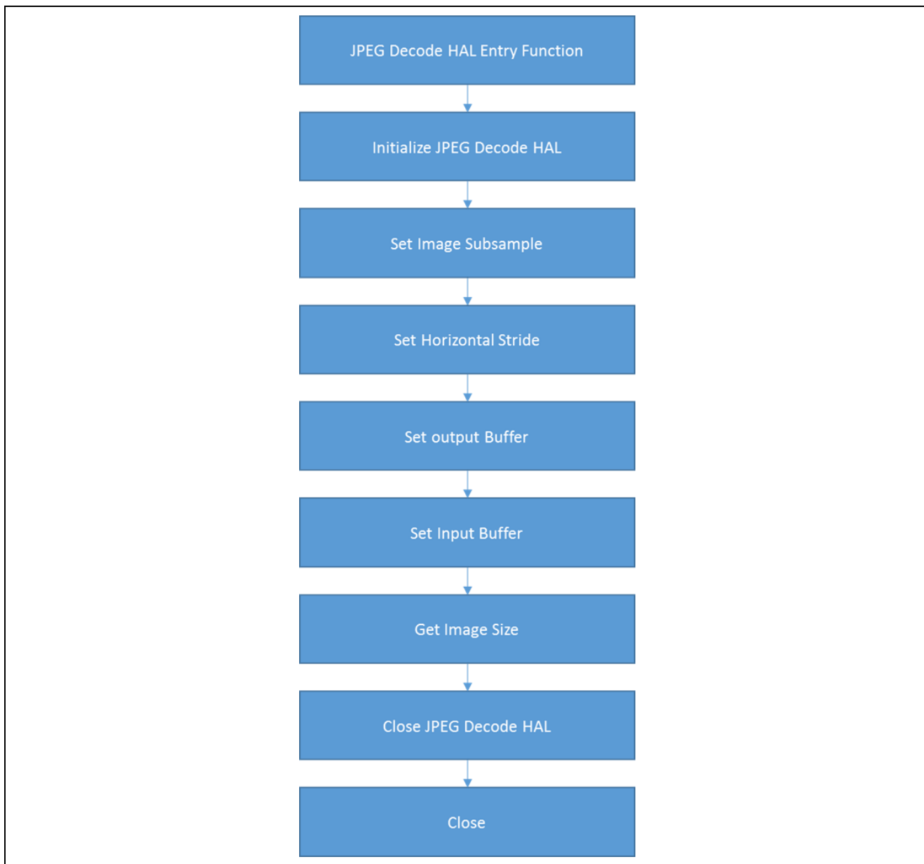
図 5 JPEG デコードフレームワークモジュールのアプリケーションプロジェクトのフロー図
