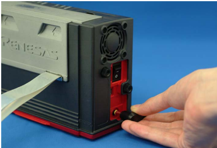
図2.5 エミュレータ用電源の接続
