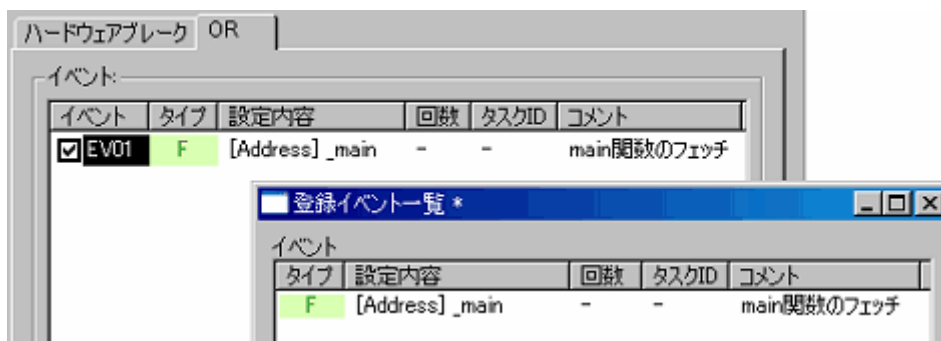
図5.37 [ハードウェアブレイク条件設定]ダイアログボックスと[登録イベント一覧]ダイアログボックス
