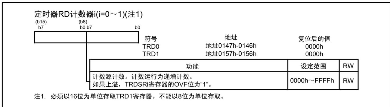
图 15.57 输出比较功能时的 TRD0 ~ TRD1 寄存器
