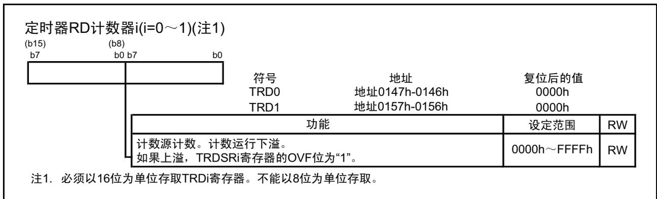
图 15.42 输入捕捉功能时的 TRD0 ~ TRD1 寄存器
