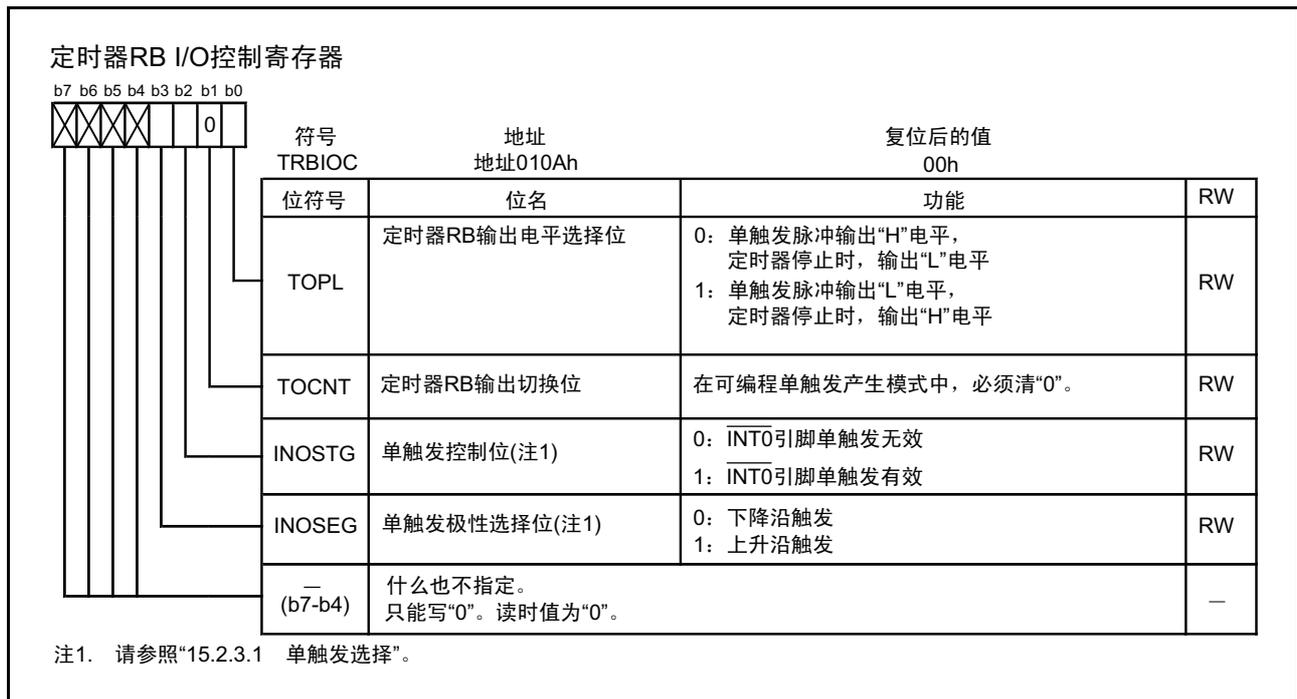
图 15.20 可编程单触发生模式时的 TRBIOC 寄存器
