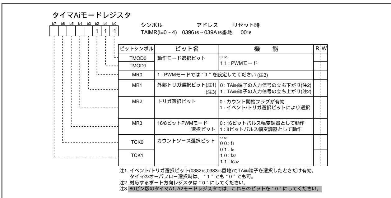
図1.17.11. パルス幅変調モード時のタイマAiモードレジスタの構成
