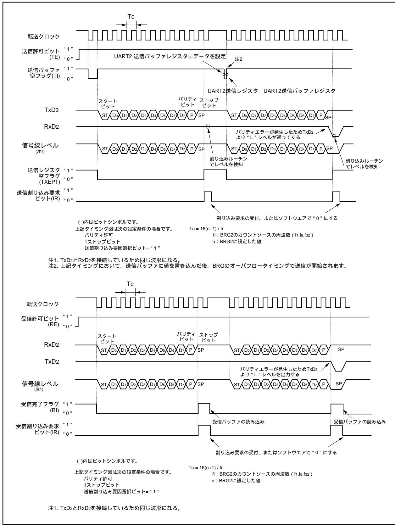
図1.19.22. UARTモード(SIMインターフェース対応)の送受信タイミング例
