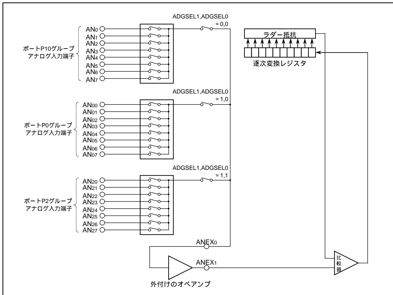
図1.20.9. 外部オペアンプ接続モードの接続例
