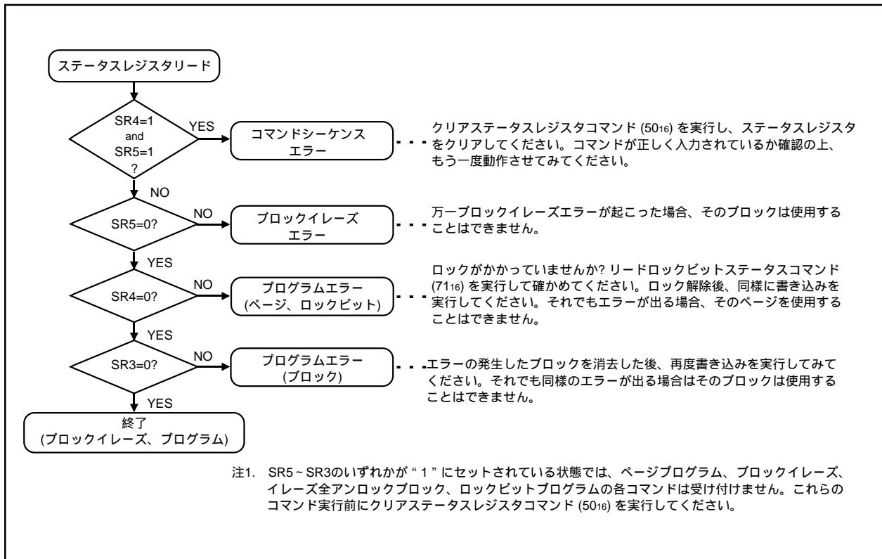
図1.31.20. フルステータスチェックフローチャートおよび各エラー発生時の対処法
