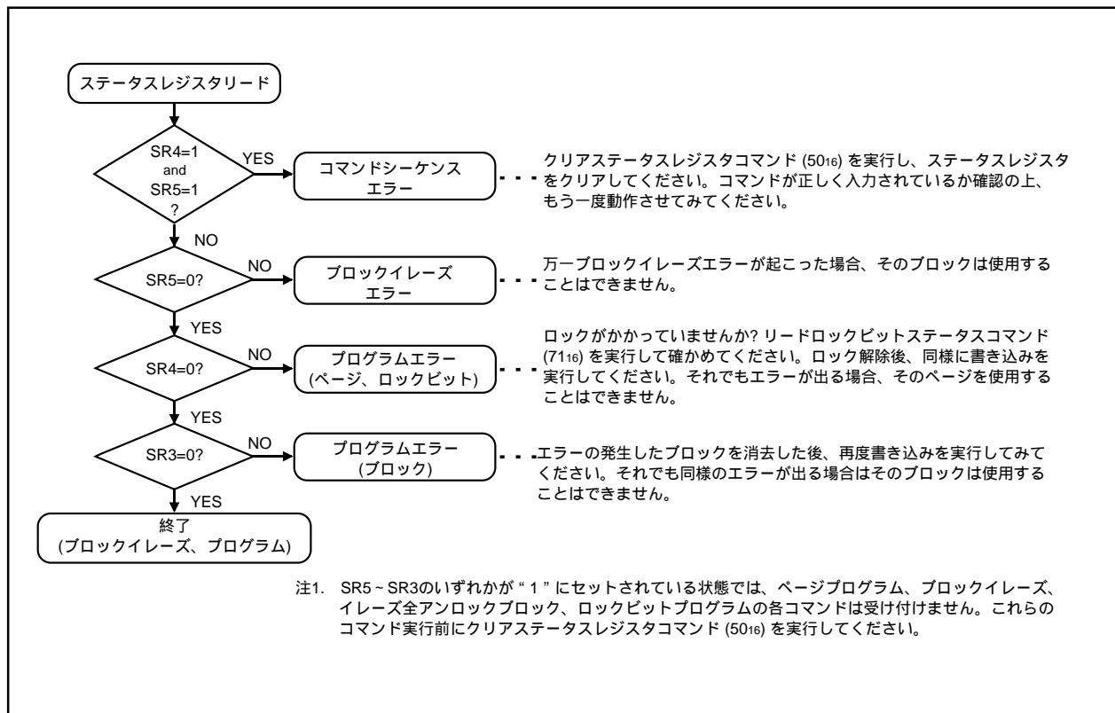
図1.28.8. フルステータスチェックフローチャートおよび各エラー発生時の対処方法
