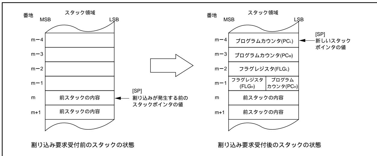
図1.14.6. 割り込み要求受付前 / 割り込み要求受付後のスタックの状態
