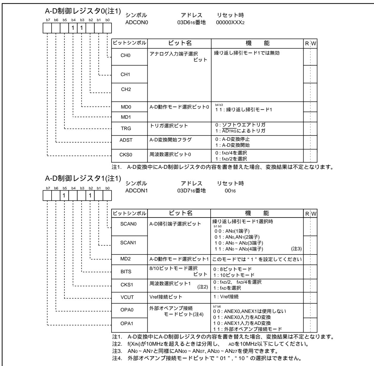
図1.20.8. 繰り返し掃引モード1時のA-D制御レジスタ
