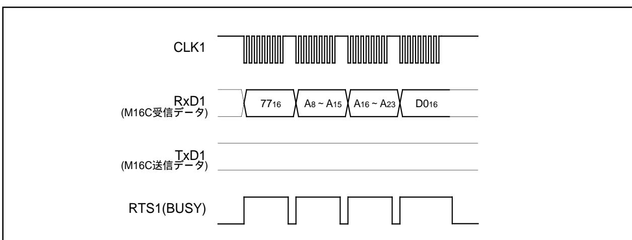
図1.31.9. ロックビットプログラムコマンド時のタイミング
