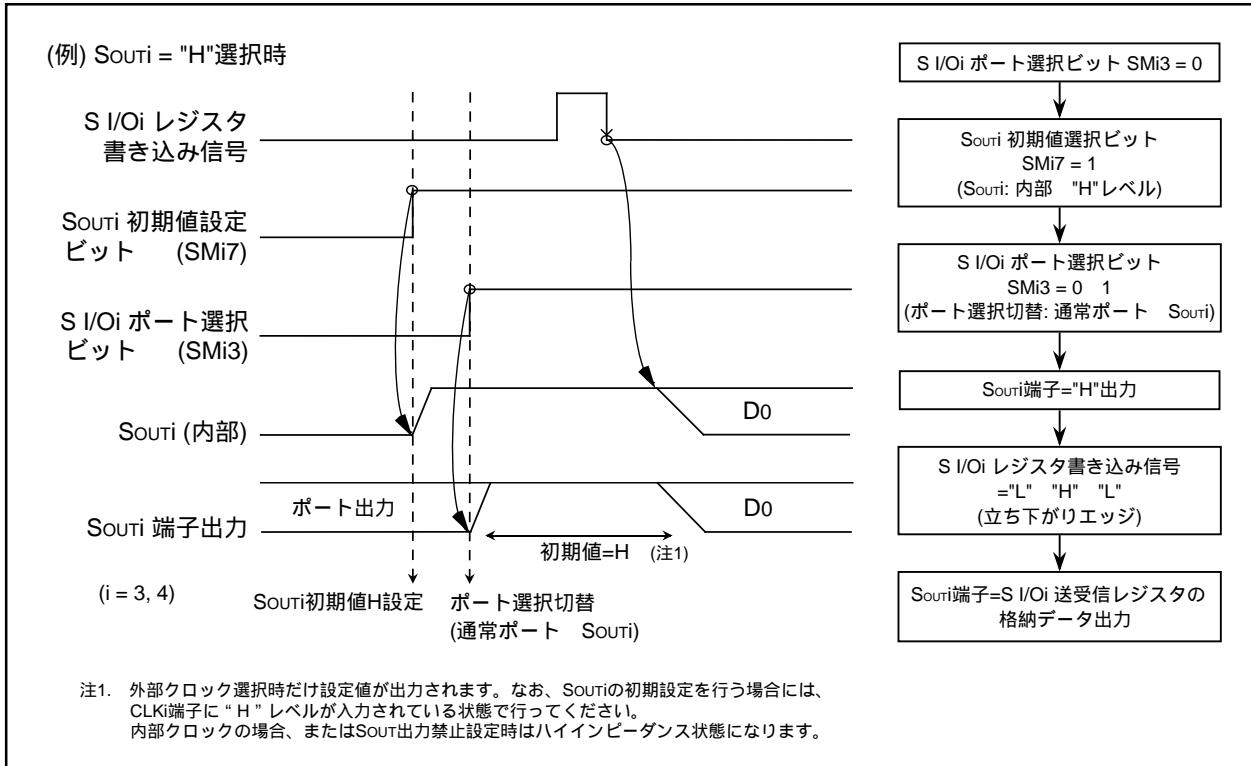
図1.19.31. SOUT<sub>i</sub>初期値設定時のタイミング図および設定方法
