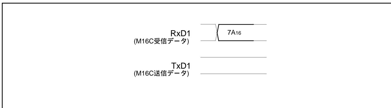
図1.31.31. ロックビット有効コマンド時のタイミング
