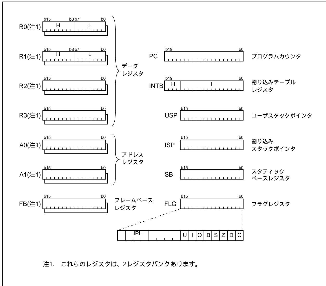
図1.5.1. 中央演算処理装置のレジスタ構成
