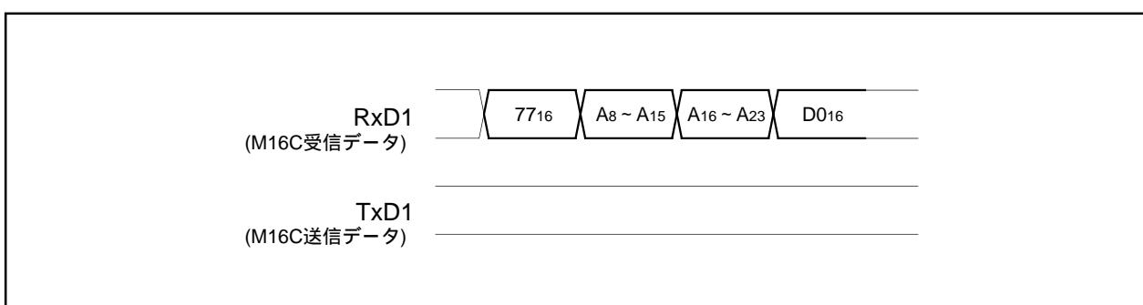
図1.31.29. ロックビットプログラムコマンド時のタイミング
