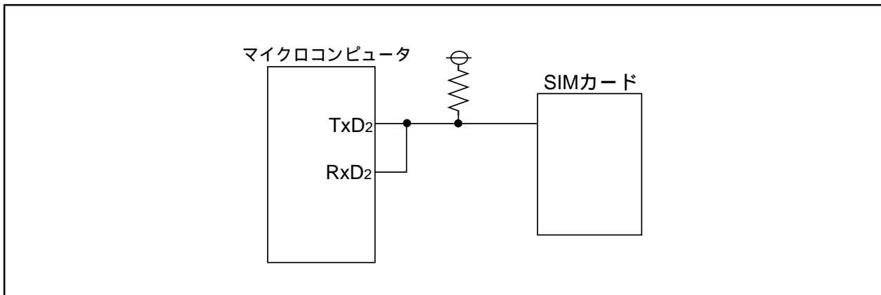
図1.19.25. SIMインターフェース接続例
