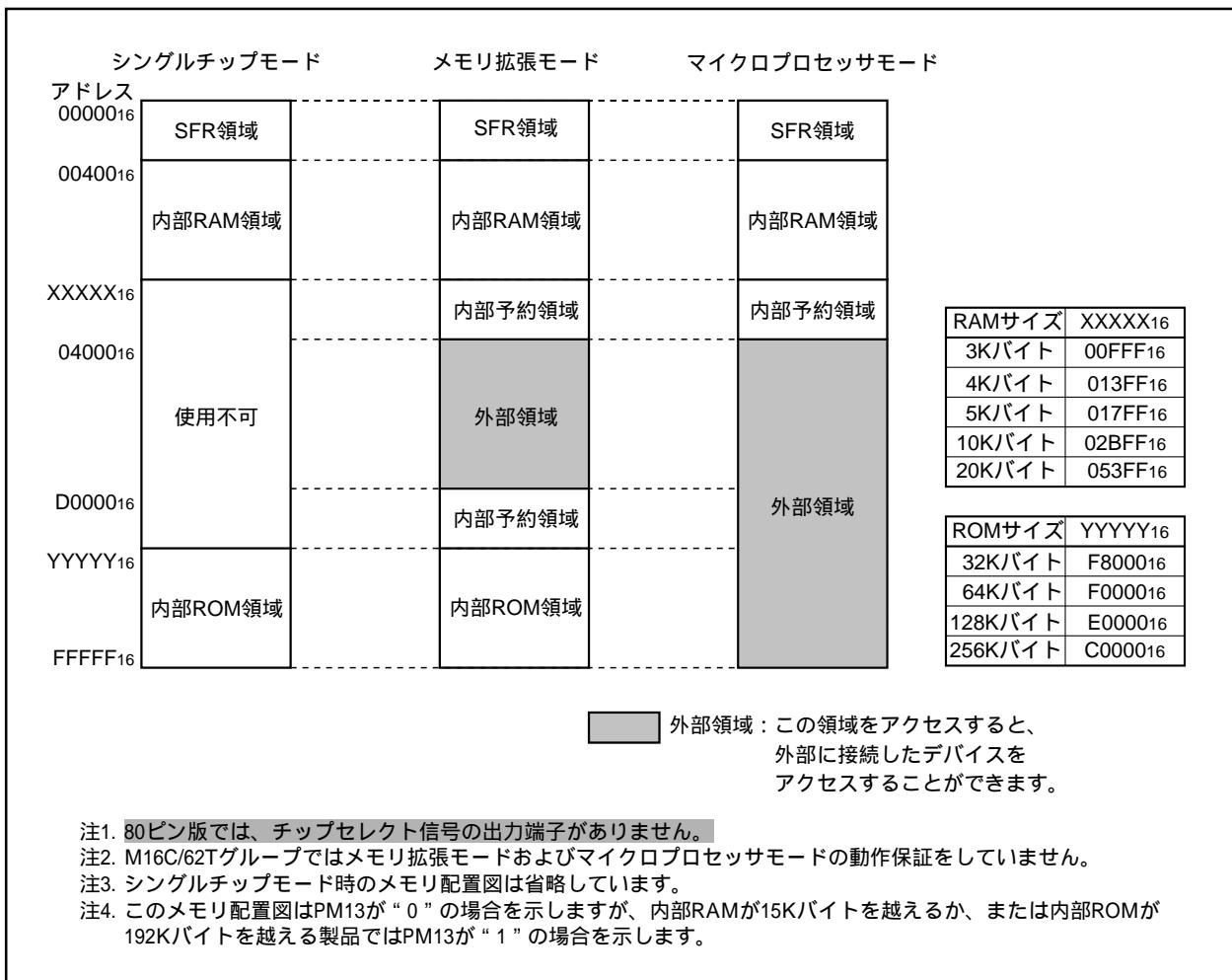
図1.10.1. 各プロセッサモード時のメモリ配置(メモリ空間拡張なし：ノーマルモード)
