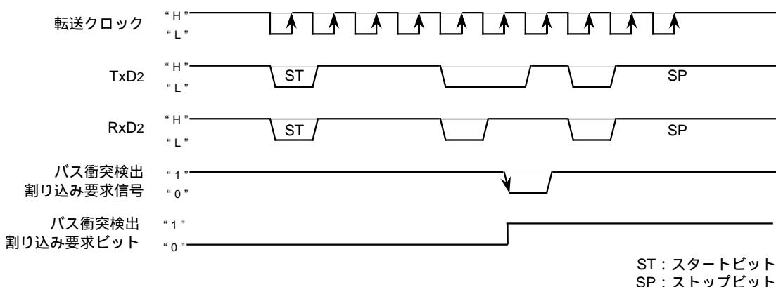
図1.19.21. バス衝突検出タイミング例(UARTモード時)
