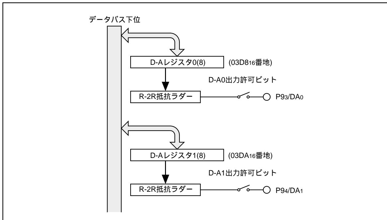
図1.21.1. D-A変換器のブロック図
