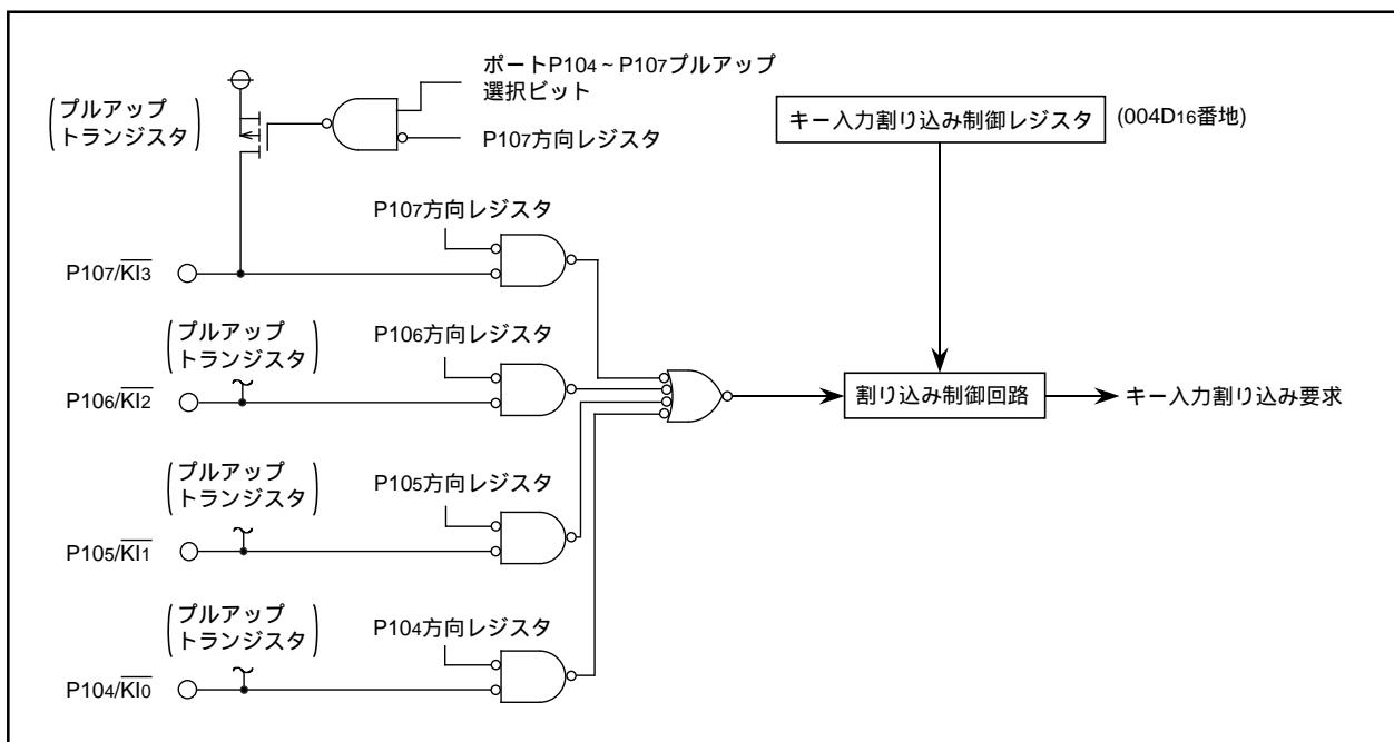
図1.14.11. キー入力割り込みのブロック図
