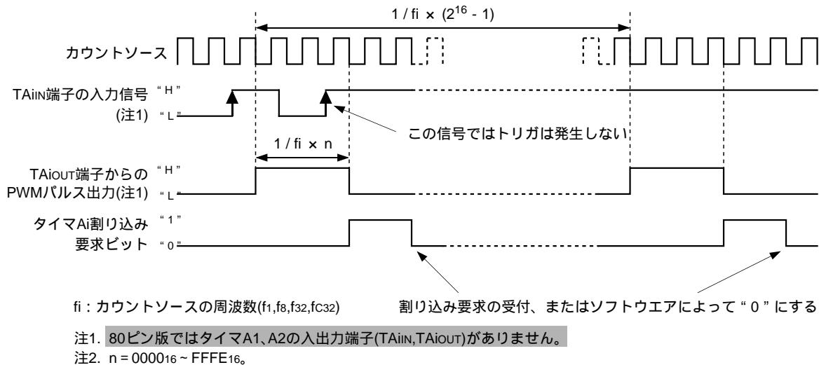
図1.17.12. 16ビットパルス幅変調器の動作例
