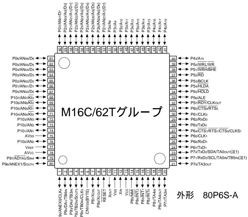
図1.1.2. 80ピン版のピン接続図(上面図)
