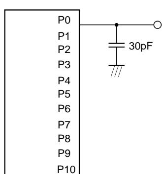
図1.26.1. ポートP0～P10の測定回路
