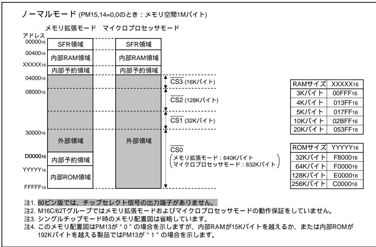
図1.8.1. ノーマルモード時のメモリ配置およびチップセレクト領域
