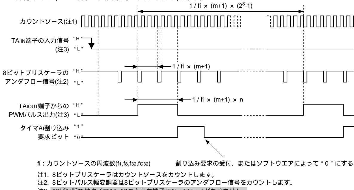
図1.17.13. 8ビットパルス幅変調器の動作例
