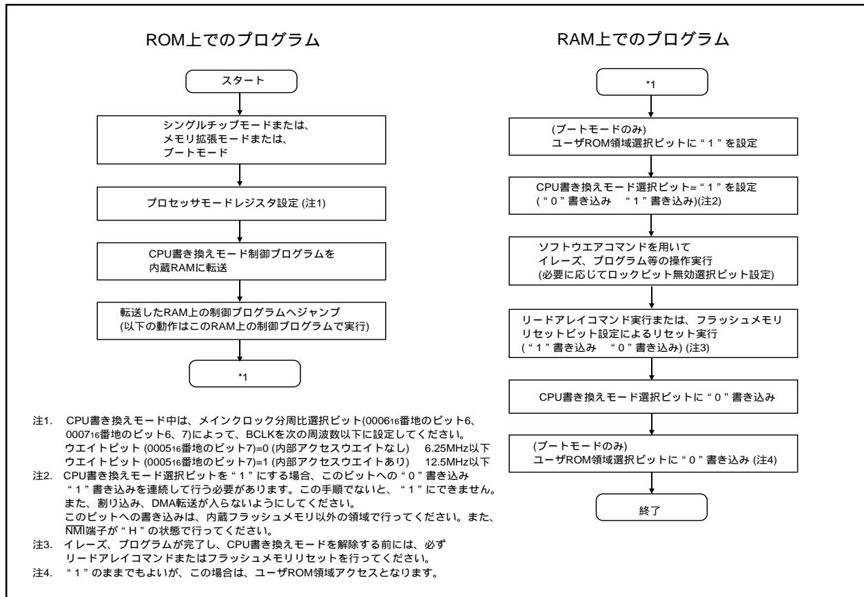
図1.28.2. CPU書き換えモードの設定/解除フローチャート
