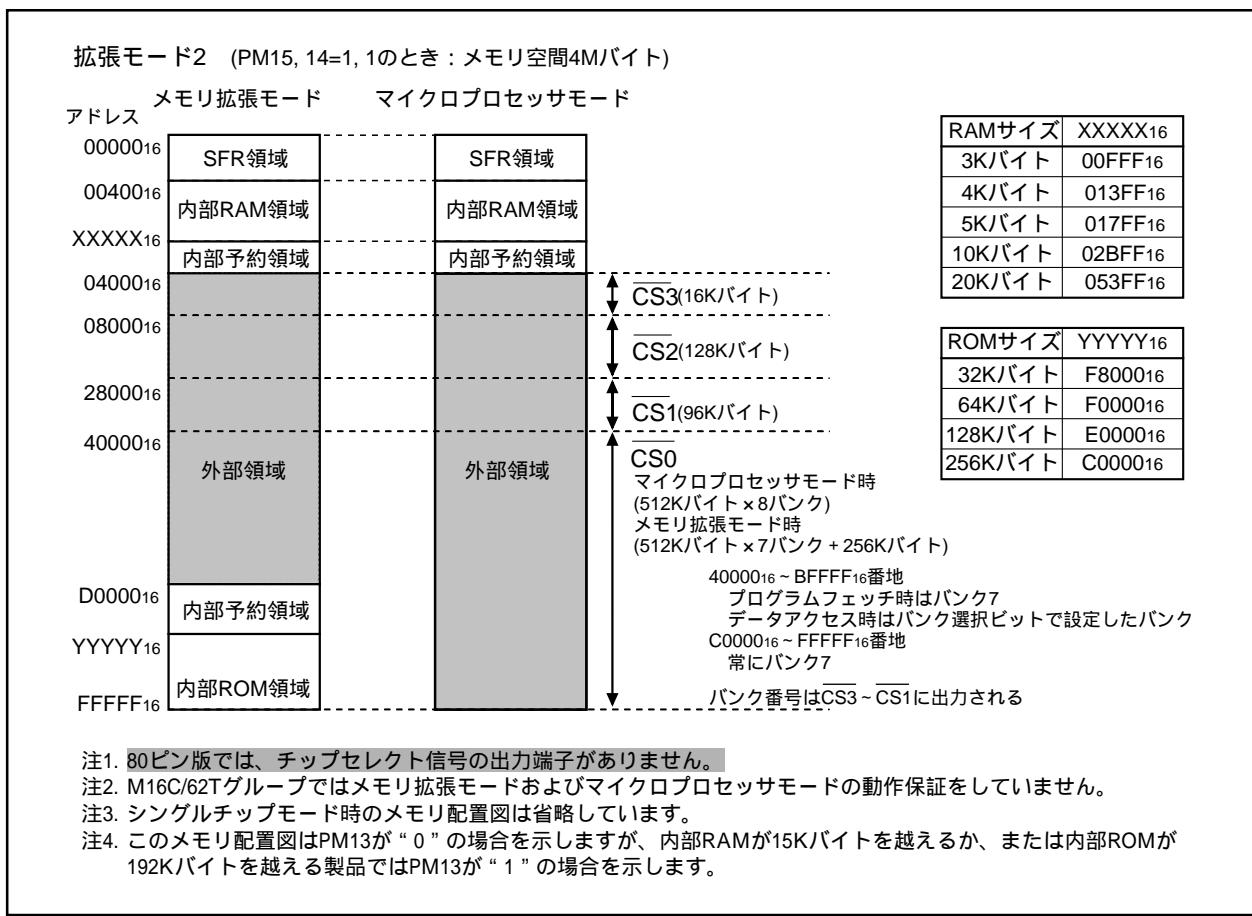
図1.8.5. 拡張モード2時のメモリ配置図およびチップセレクト領域
