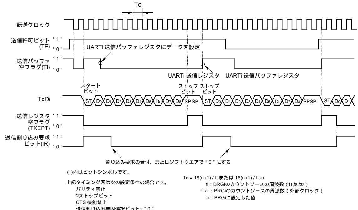
図1.19.16. UARTモード時の送信タイミング例(UART0、UART1)
