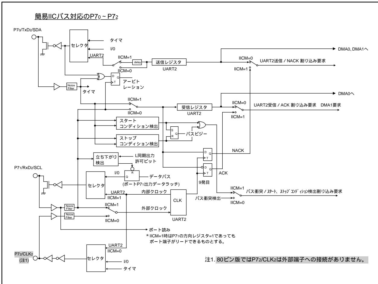
図1.19.27. IICモード機能ブロック図
