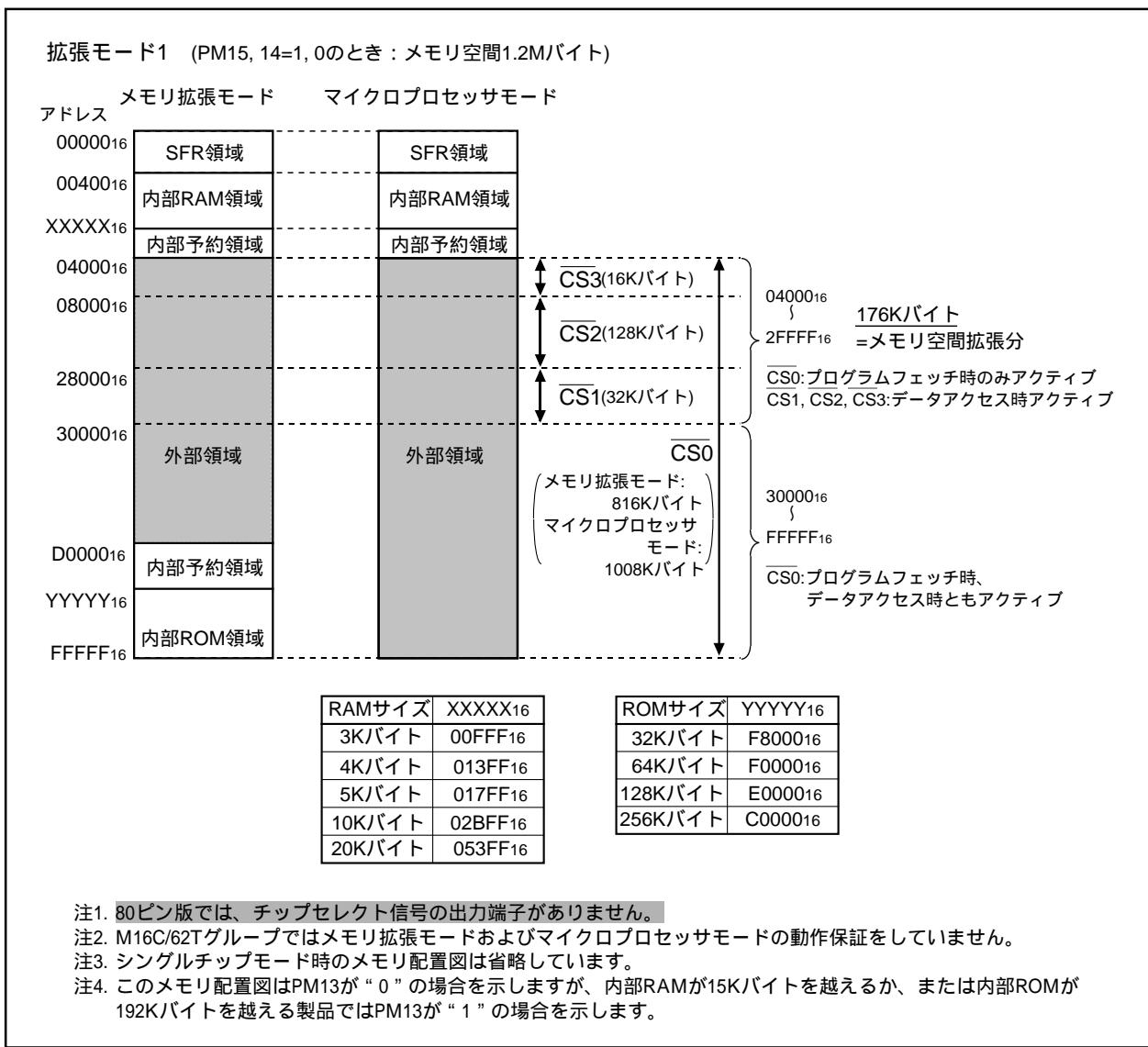
図1.8.2. 拡張モード1時のメモリ配置図およびチップセレクト領域
