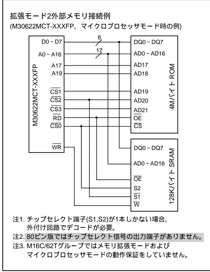
図1.8.6. 拡張モード2時の外部メモリ接続例
