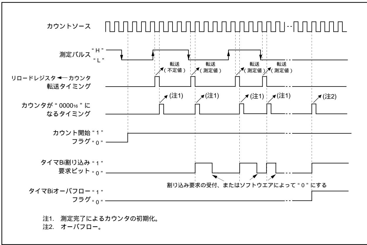
図1.17.21. パルス幅測定時の動作図
