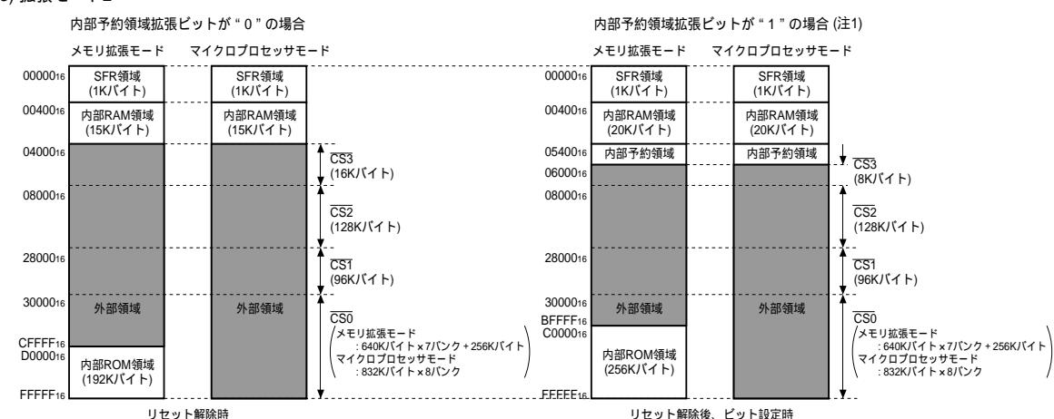
図1.10.2. 各プロセッサモード時のメモリ配置およびチップセレクト領域
