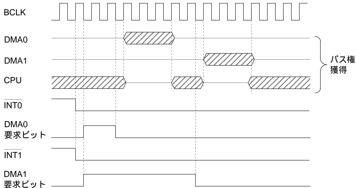
図1.16.6. 外部要因によるDMA転送例
