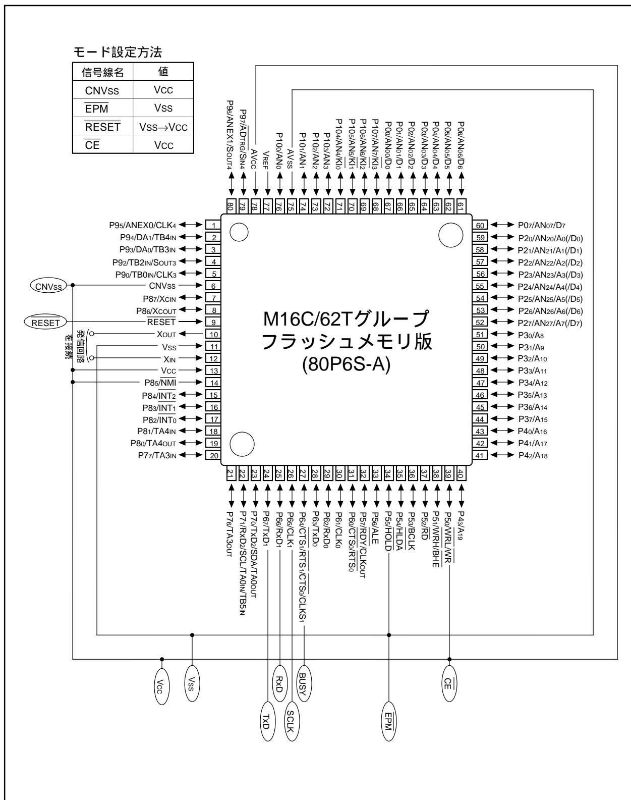
図1.31.2. シリアル入出力モード時の端子結線図(80ピン版)
