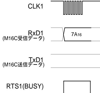
図1.31.11. ロックビット有効コマンド時のタイミング
