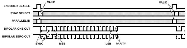
FIGURE 4. ENCODER TIMING
