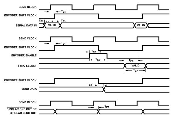
FIGURE 10. ENCODER TIMING
