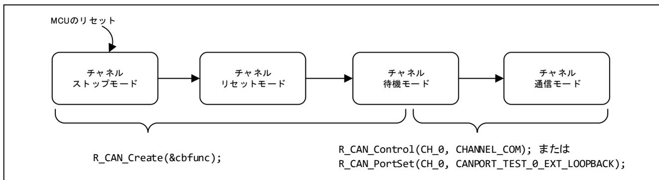
図 3-2 チャンネルモードの状態遷移図
