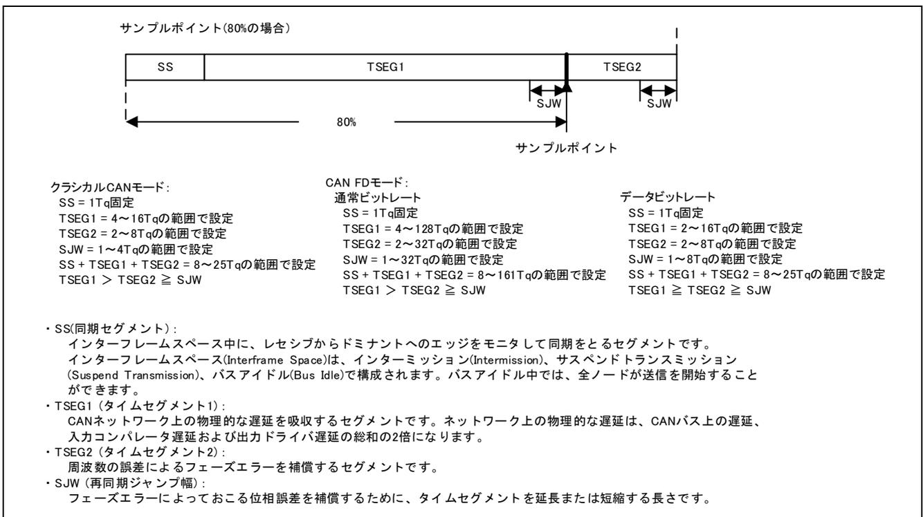
図 3-3 ビットのセグメント構成とサンプルポイント
