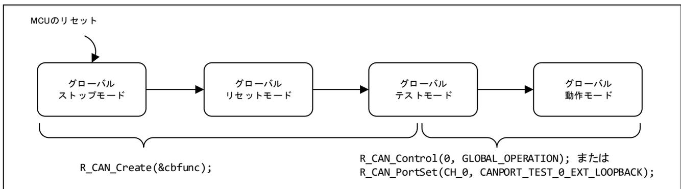
図 3-1 グローバルモードの状態遷移図
