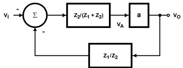
FIGURE 7. BLOCK DIAGRAM OF THE INVERTING OP AMP
