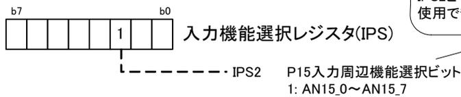
IPS2ビットを“0”(AN15\_0~AN15\_7以外)にしてもAN15\_0~AN15\_7は使用できますが、電源電流が増加する場合があります。
