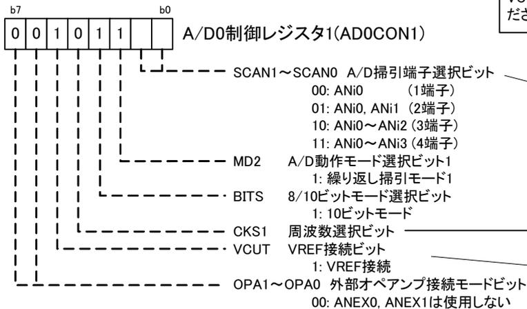
重点的にA/D変換する端子を選択します。
