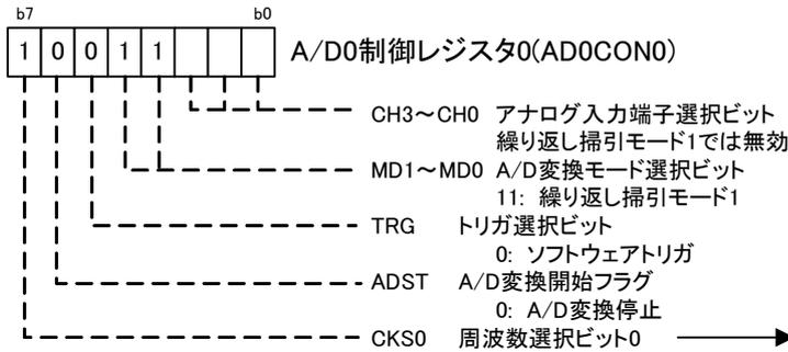
A/Dコンバータの動作クロック( $\phi$ AD)はAD0CON0レジスタのCKS0ビット、AD0CON1レジスタのCKS1ビット、AD0CON3レジスタのCKS2ビットで選択します。
