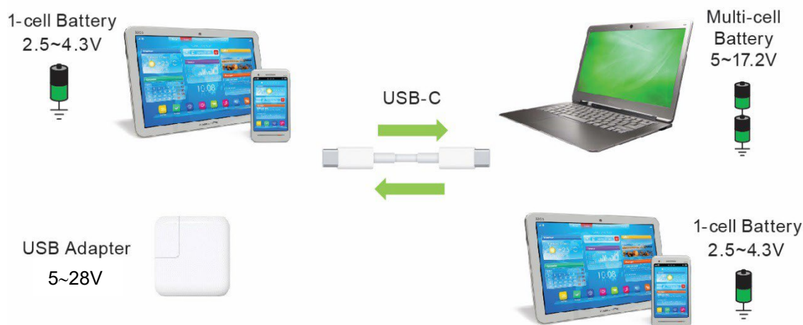
図2. USB Type-C ベースの電力供給アーキテクチャ
