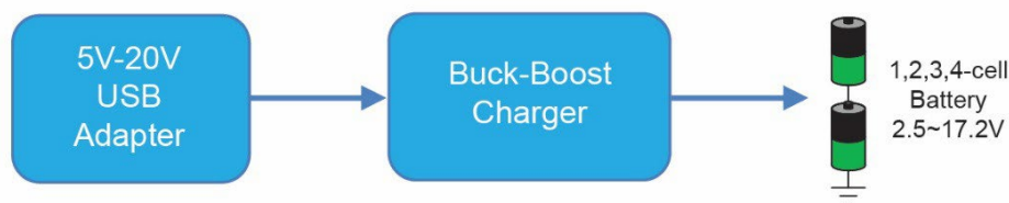
図5. バックブーストチャージャー方式
