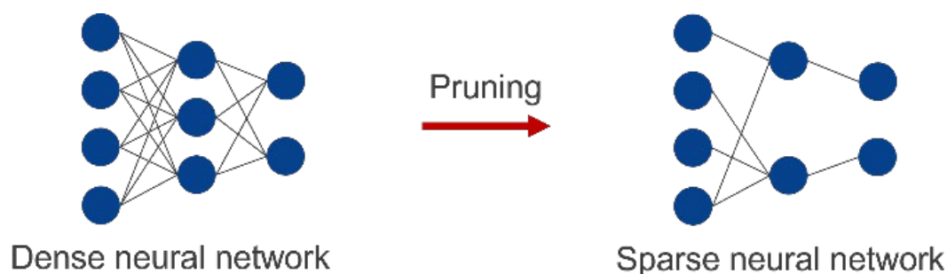
図 7: 枝刈りによるモデルの軽量化
