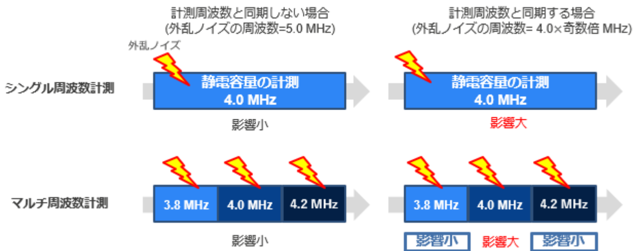
図 1 : シングル周波数計測とマルチ周波数計測の外乱ノイズの影響
