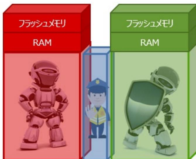
図 2. ノンセキュア・コーラブル・ベニア (NSCV) が、ノーマルワールドからセキュアワールドのサービスにアクセスできるアクセスポイントとして機能
