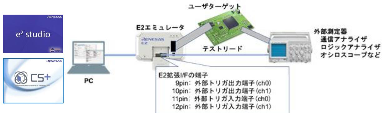
統合開発環境 e2 studio および CS+ のデバッグ機能(以降デバッガ)は、外部トリガの入出力を条件として、デバッガと外部測定器を連動させてプログラムや外部測定器の波形測定を停止させますので、異常検出時にデバッガで問題箇所を特定して簡単に検証することができます。
